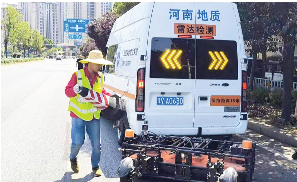
工作中的三维探地雷达检测车
