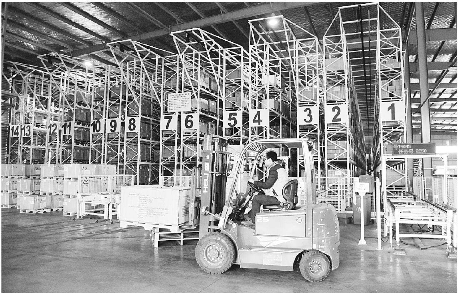
南阳飞龙汽车零部件有限公司自主研发并建成立体化全智能仓库,降低了差错风险,效率提升50% ③11
