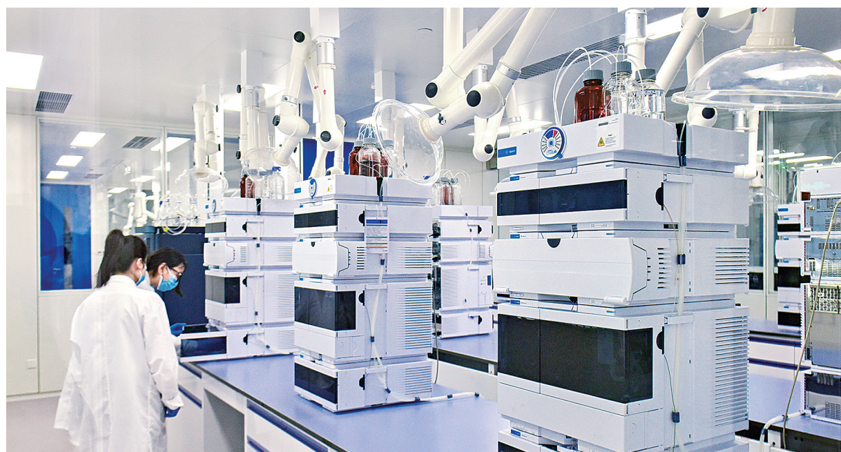
在精密仪器检测室内,工作人员使用高效液相色谱仪进行检测。②8
