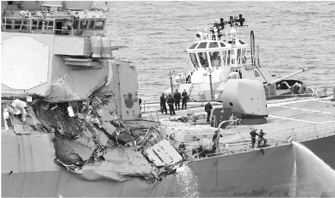
“菲茨杰拉德”号驱逐舰舰体右侧吃水线上下受损,无沉没风险。
