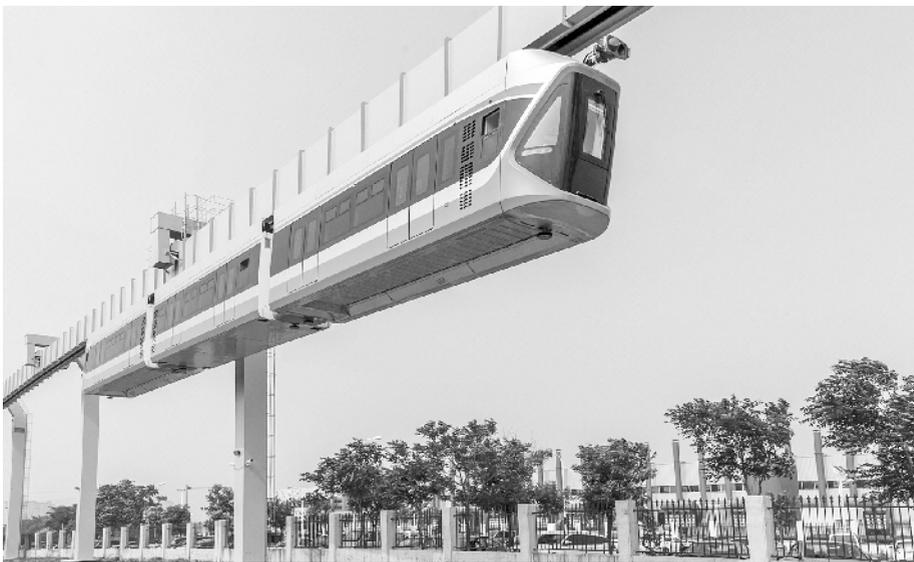
记者从中车青岛四方机车车辆股份有限公司了解到,国内最高速的悬挂式单轨列车日前在中车四方下线,进入型式试验和试运行阶段,其设计时速为80公里,最高运行时速为70公里。图为列车在试验中(资料照片)。⑥4 新华社
